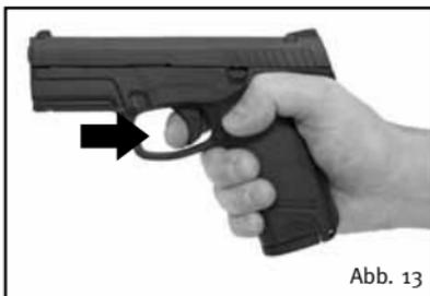
Zur Schussabgabe ziehen Sie den Abzug mit dem Zeigefinger der Schießhand in die hinterste Position. Dadurch wird automatisch die Abzugsicherung und die Fallsicherung deaktiviert.
