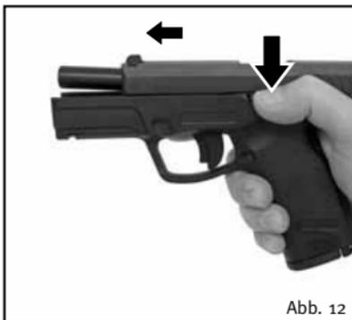
5. Lösen Sie mit dem Verschlussfang das Verschlussstück, sodass das Verschlussstück selbsttätig in die vorderste (geschlossene) Stellung kommt.
