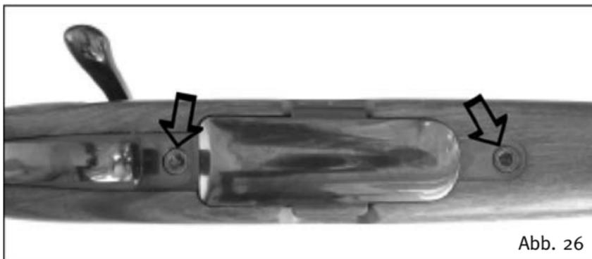
Werden diese Schrauben gelöst, müssen sie mit einem Drehmomentschlüssel (7 Nm) festgezogen werden.
