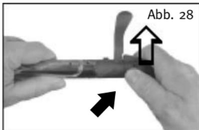
1. Verschluss in die linke Hand nehmen. Mit dem Daumen der rechten Hand die Sperrklappe hineindrücken und gleichzeitig die Verschlusskappe im Uhrzeigersinn (Pfeilrichtung = Drehrichtung) bis zum hörbaren Entriegeln drehen.
